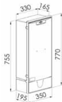
Schéma coffret ECP2D
