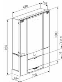
Schéma borne REMBT 600
