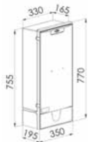
Schéma coffret REMBT 300
