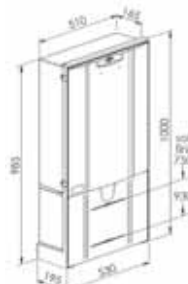
Schéma borne REMBT 300
