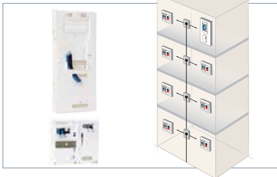
Branchement Consommateur monophasé ou triphasé + neutre
