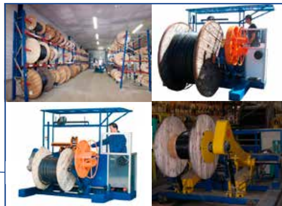
Atelier de coupe : de la couronne au touret de 2.6 m et 5 t
